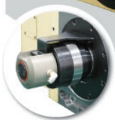
油圧引込装置
